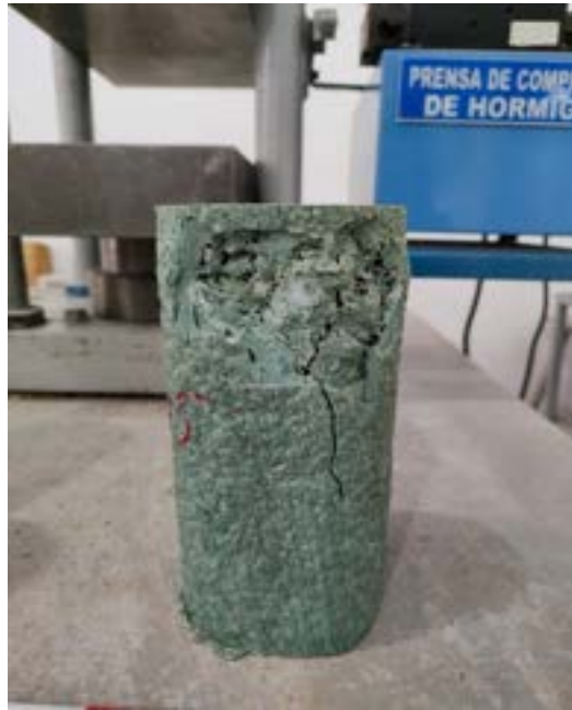
Figura 13: Probeta de plástico tipo 5 luego del ensayo a compresión Fuente: Los autores
