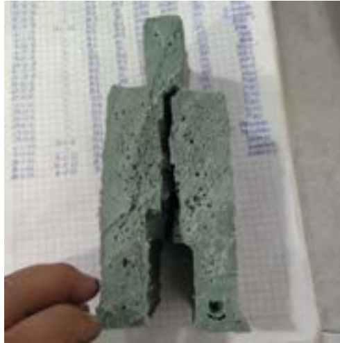
Figura 20: Sección de corte en el ensayo de resistencia a cortante plástico tipo 5
