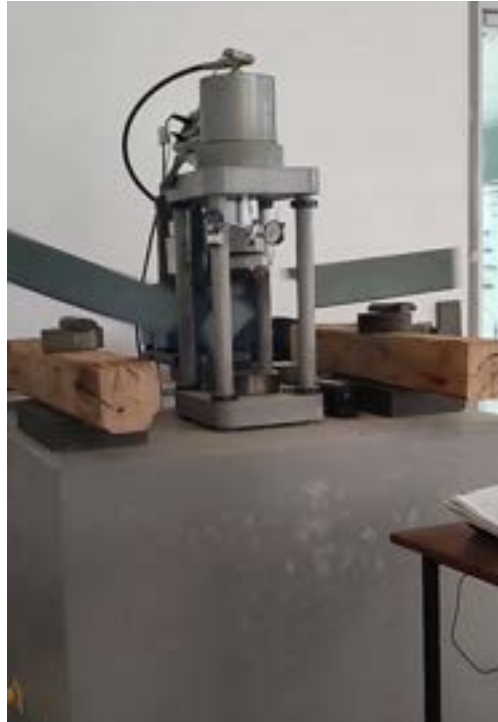
Figura 5: Elemento de plástico tipo 5 fallando en ensayo de resistencia a flexión
