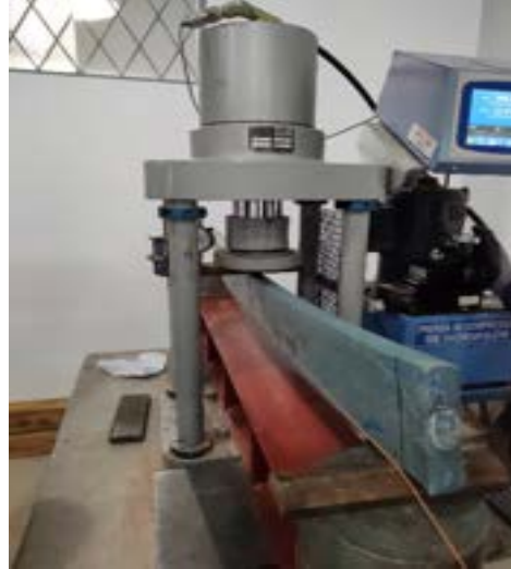
Figura 2: Vigas de plástico extruido en ensayo de resistencia a flexión Fuente: Los autores
