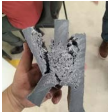
Figura 19: Sección de corte en el ensayo de resistencia a cortante plástico tipo 2 Fuente: Los autores
