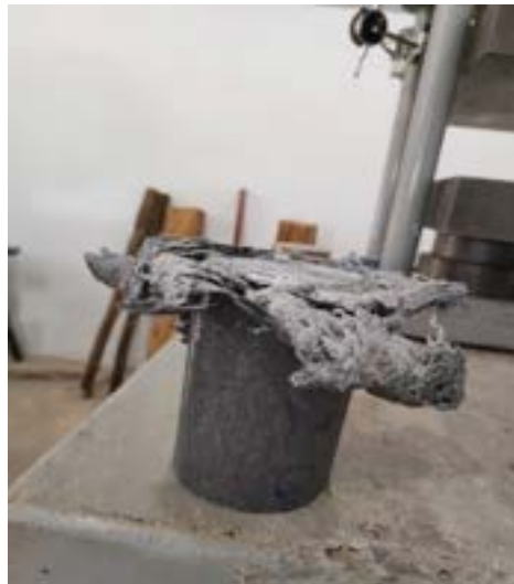
Figura 12: Probeta plástico tipo 2 luego del ensayo a compresión
