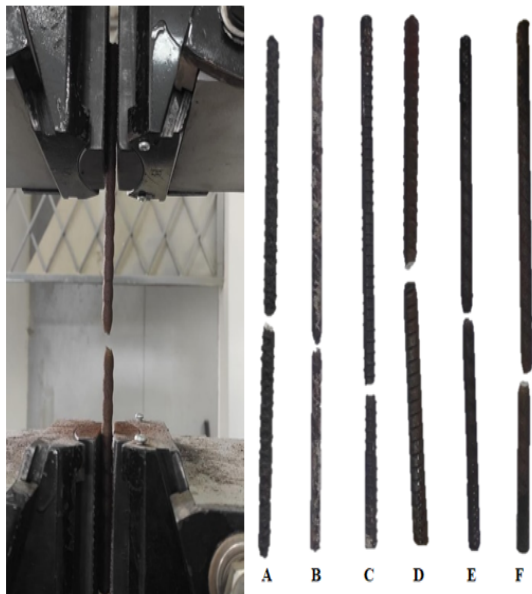
Figura 2. Ruptura de varillas en el ensayo de tracción.
