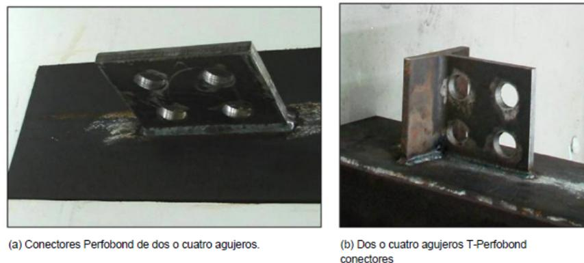
Figura 9: Geometrías típicas de los conectores probados por (Vianna et al., 2009)
